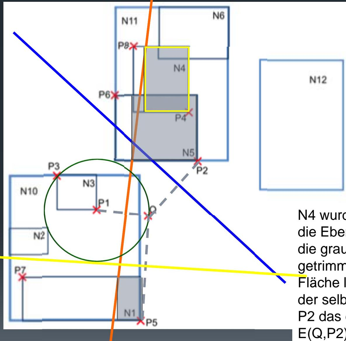
N4 wurde zuvor durch die Ebene  $E(Q, P1)$  auf die graue Fläche getrimmt. Die graue Fläche liegt jedoch auf der selben Seite von P2 das eine Ebene  $E(Q, P2)$  aufstellt  $\rightarrow$  schließ N4 aus!
