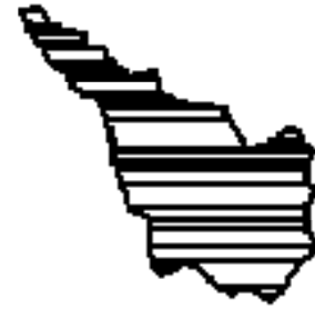
Zerlegung in Trapeze
