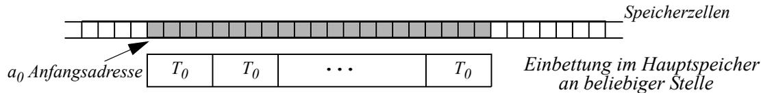
Die **Adresse der i-ten Komponente** ist:  $a_0 + (i - 1) \cdot SIZE(T_0)$ , wobei  $SIZE(T_0)$  die Anzahl der von  $T_0$  benötigten Speicherzellen angibt. Diese Funktion nennt man auch eine **Adressfunktion**.
