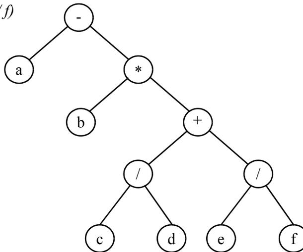
Der **Grad** eines Knotens  $x$ ,  $deg(x)$ , ist gleich der Anzahl der Teilbäume von  $x$ . Gilt  $deg(x) = 0$ , so nennt man  $x$  ein **Blatt**.
