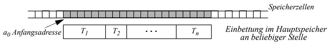
Der Compiler kennt den Speicherbedarf der Grundtypen und kann bereits während des Compilervorganges die **offsets** der einzelnen Selektoren berechnen mit:
