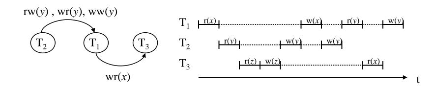
Serialisierungsreihenfolge: (T<sub>2</sub>, T<sub>1</sub>, T<sub>3</sub>)
