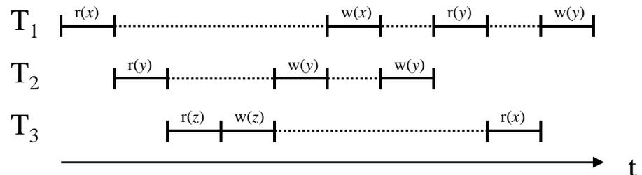
Serialisierungsreihenfolge:  $(T_2, T_1, T_3)$
